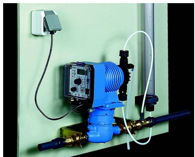
Fig 2. Kalibrering av pump från graderat nivårör
